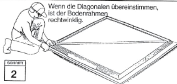
Der Bodenrahmen muß absolut rechteckig und eben aufliegen. Sonst stimmen später bei der weiteren Montage die Bohrungen nicht überein.
