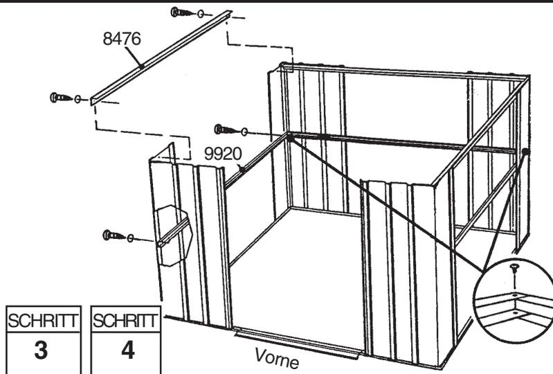
**5** Die **Türlaufschienengruppe** mit selbstschn. Schrauben entlang der Oberseite der vorderen Wandpaneele befestigen. Siehe Zeichnung.
