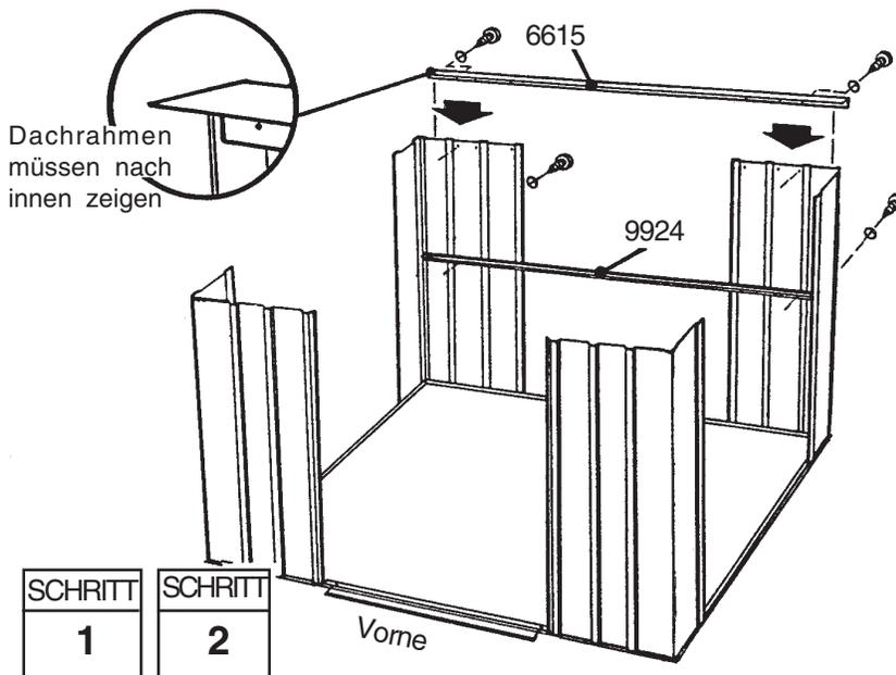
**1** Die **hintere Dachrahmengruppe** mit selbstschn. Schrauben entlang der oberen Rückwand befestigen.
