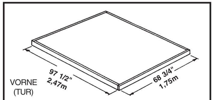
**HINWEIS:** Die Abmessungen in der Zeichnung sind die Maße des Fundamentes, nachdem der Holzrahmen entfernt wurde.
