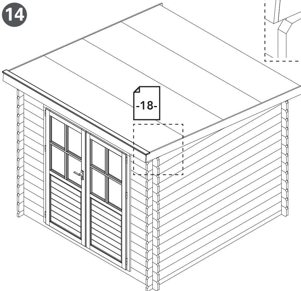
Bevestigen gevellijs & afdeklijst - Befestigen Giebelleiste & Dachabschlussleiste
