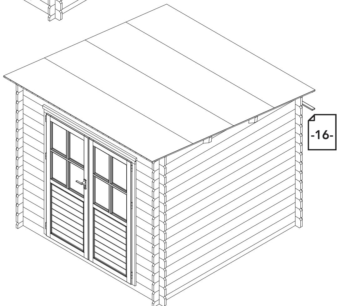
Bevestigen gevellijs & afdeklijst - Befestigen Giebelleiste & Dachabschlussleiste
