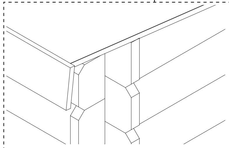
Bevestigen gevellijs & afdeklijst - Befestigen Giebelleiste & Dachabschlussleiste
