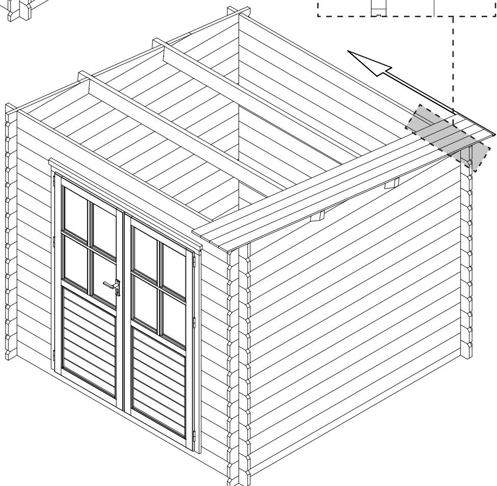
Bevestigen dakhout & dakbedekking - Platzierung Dachbrett & Dacheindeckung
