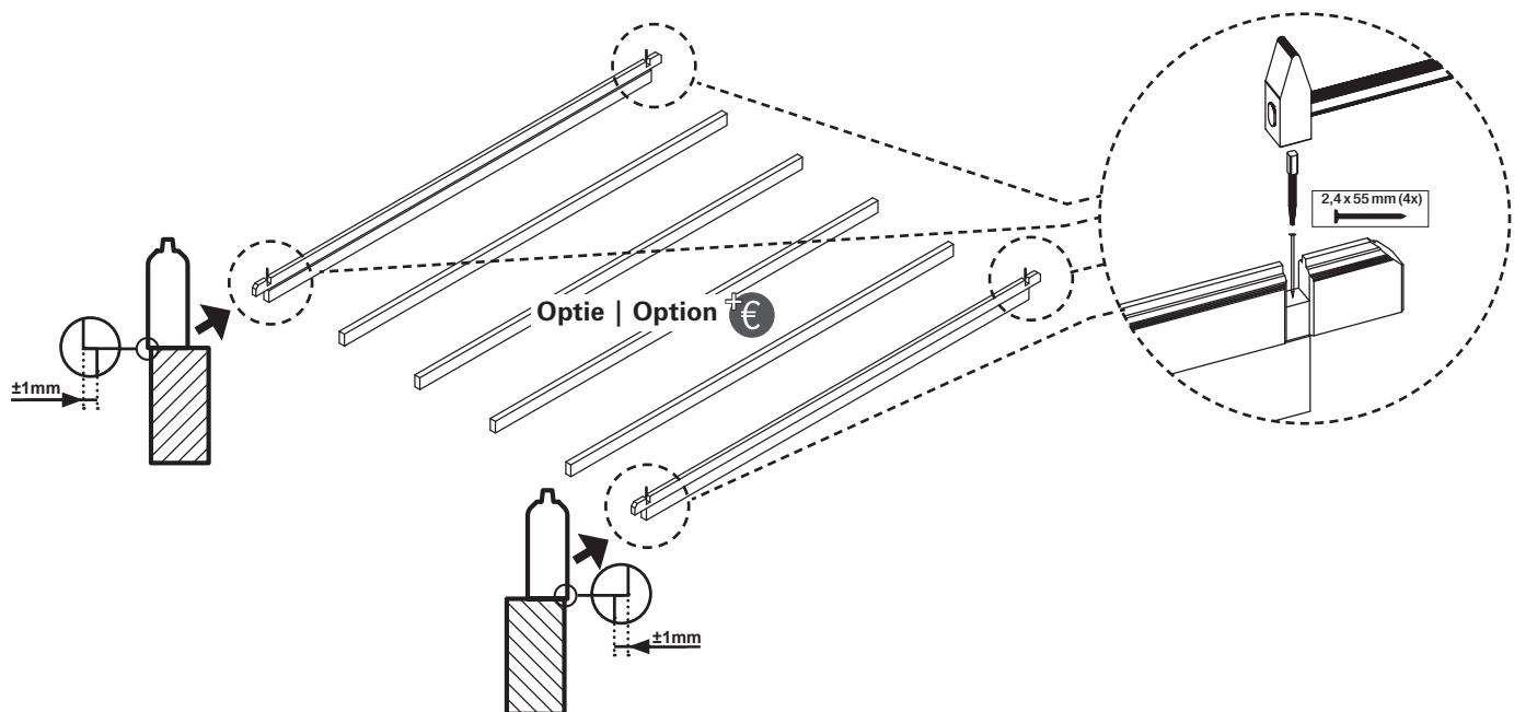
Leggen vloerbalken (optie) & Plattegrond - Fussbodenbalken (Option) & Lageplan
