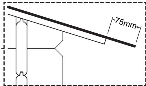
Bevestigen dakbedekking - Befestigen Dacheindeckung
