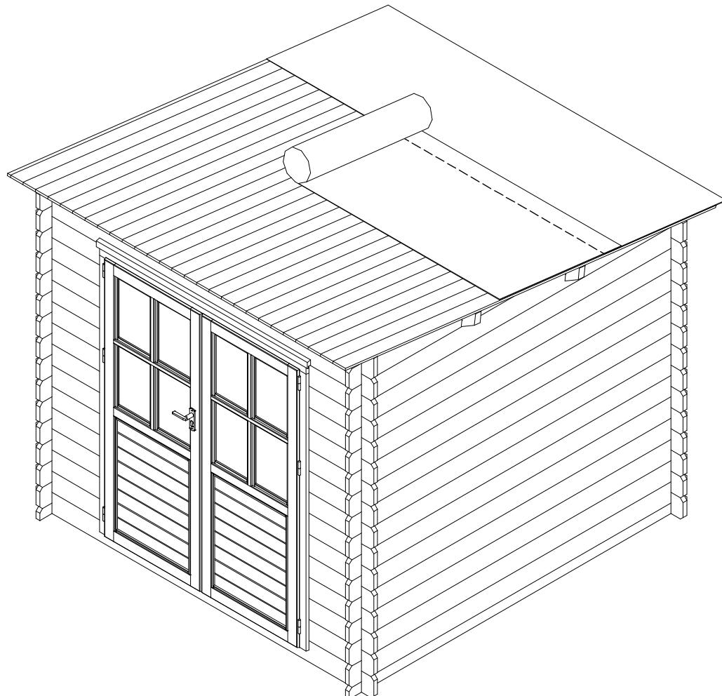
Bevestigen dakbedekking - Befestigen Dacheindeckung
