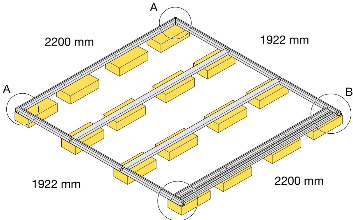
Frontansicht mit gleichstarken Betonplatten
