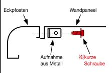
An der Stelle, wo der Eckpfosten befestigt ist, wird er mit einer  $\frac{1}{2}$  kurzen Schraube des Metallhauses verschraubt.
