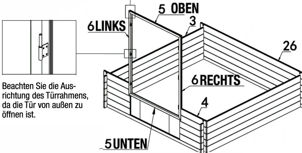
Beachten Sie die Ausrichtung des Türrahmens, da die Tür von außen zu öffnen ist.
