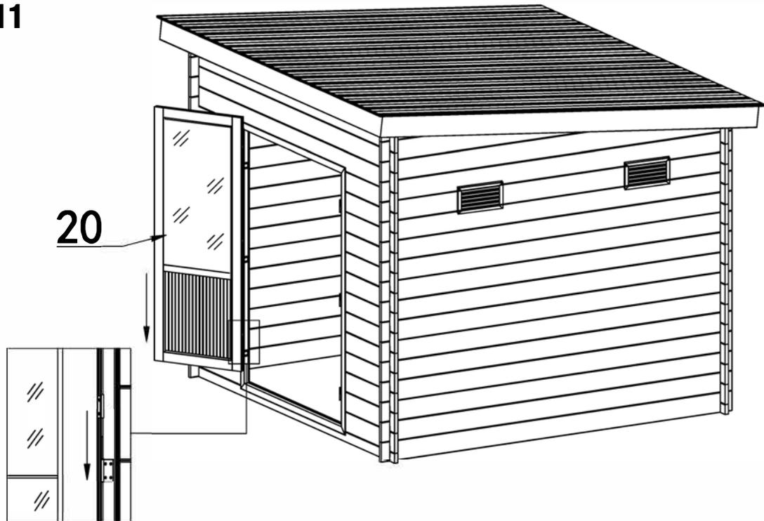
Beachten Sie die Ausrichtung des Türrahmens, da die Tür von außen zu öffnen ist.
