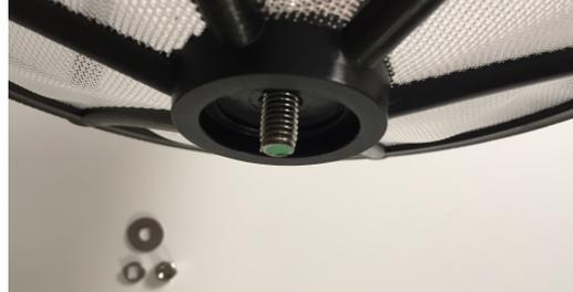
Mitgelieferte Mutter, Federring sowie Unterlagsscheibe lösen. Gewindestange durch das bereits gebohrte Loch im Filterkorb stecken. Unterlagsscheibe, Federring sowie Mutter aufsetzen und festziehen.
