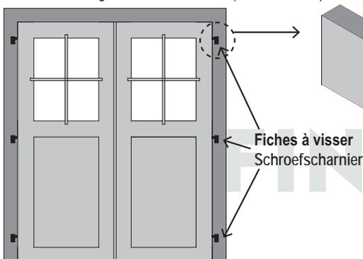
d'une porte à deux battants, le battant de verrouillage doit toujours être fixé en haut et en bas avec les ferrures prévues à cet effet.
