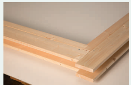
9. Ansicht fertig montierter Rahmen oben rechts
