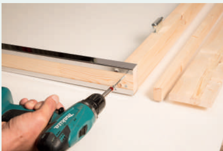
4. Anschrauben der unteren Türschwelle
