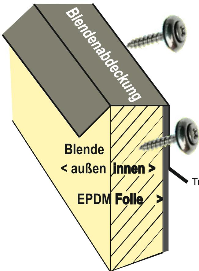
Verschraubung in den 4 Ecken und am Profilstoß, dann alle 50 cm. Sie schrauben von innen durch das Blech, durch die Folie ins Holz der senkrechten Blende.
