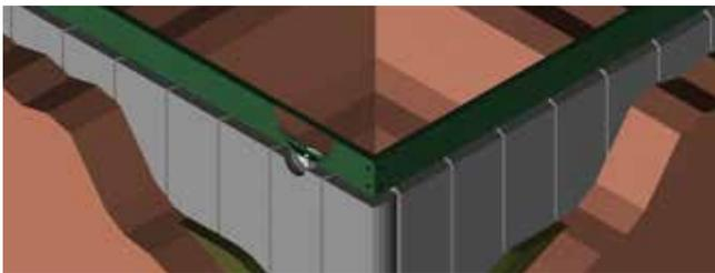
Die Fundamentierung mit Fertigbaubohlen, wie z.B. dem Betonstein, der senkrecht in die Erde gelassen wird, weist eine ähnliche Funktionsweise wie das Streifenfundament auf.
