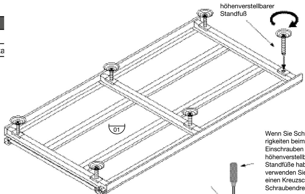
Die höhenverstellbaren Standfüße so weit einschrauben, dass die Unterkante der Standfüße 0 – 10 mm beträgt.
