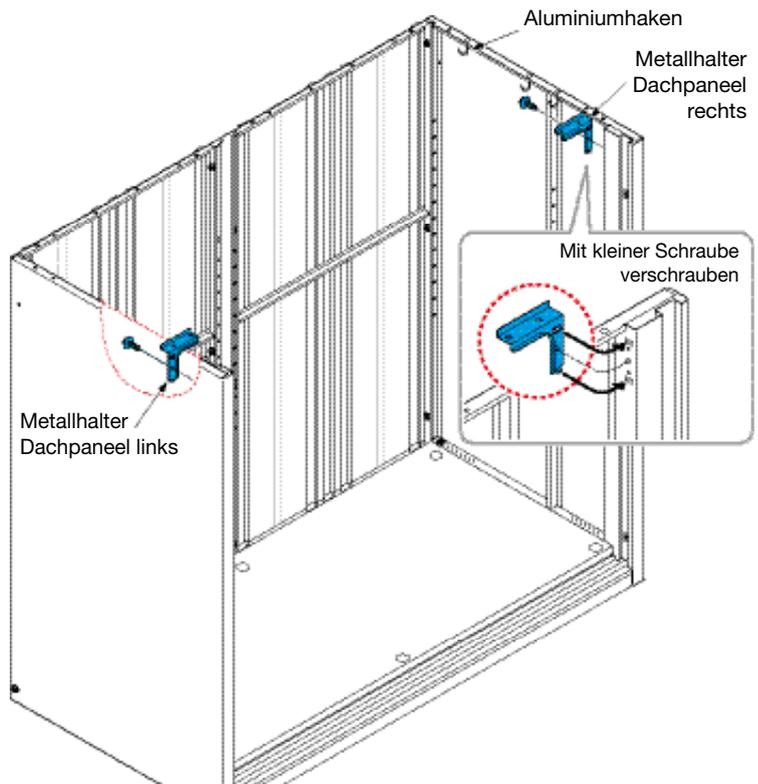
Die Schrauben dürfen nur handfest verschraubt werden, da sonst Schwierigkeiten bei der späteren Dachpaneel-Montage auftreten können. Die Aluminiumhaken müssen vor der Dachpaneel-Montage eingehakt werden, da an manchen Stellen es im Nachhinein nicht mehr möglich ist.
