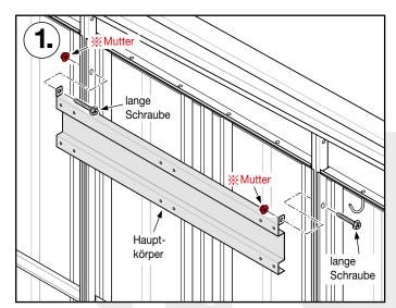
Bitte achten Sie bei der Montage des Grundträgers auf die unterschiedlichen Schrauben. Benutzen Sie für die Verschraubung die gekennzeichneten <u>X Muttern</u> des Metallhauses.
