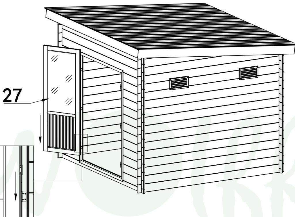
Beachten Sie die Ausrichtung des Türrahmens, da die Tür von außen zu öffnen ist.
