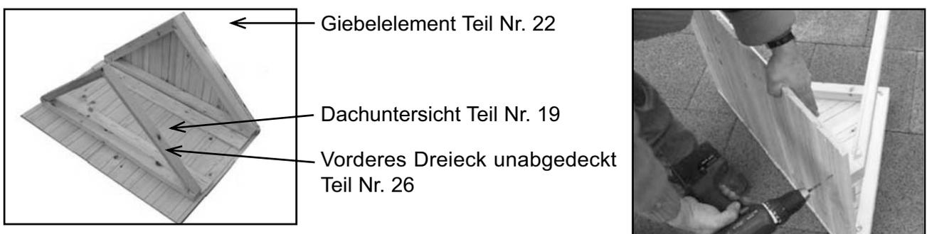
2. Legen Sie die beiden Dachplatten Nr. 17 und 18 auf die Gaube und verschrauben Sie diese wiederum mit passenden Schrauben. Die restlichen Einzelteile, wie zum Beispiel Teil Nr. 20, 23, 27 etc. werden wie oben im Detail positioniert und mit Schrauben befestigt.
