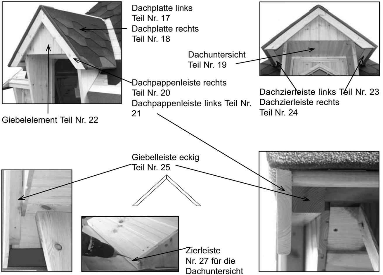
1. Nehmen Sie die Dachunterseite Nr. 19 und legen Sie dieses verkehrt auf den Boden. Nun werden die Teile Nr. 22 und Nr. 26 montiert. Verbinden Sie alle Einzelteile mit passenden Schrauben.
