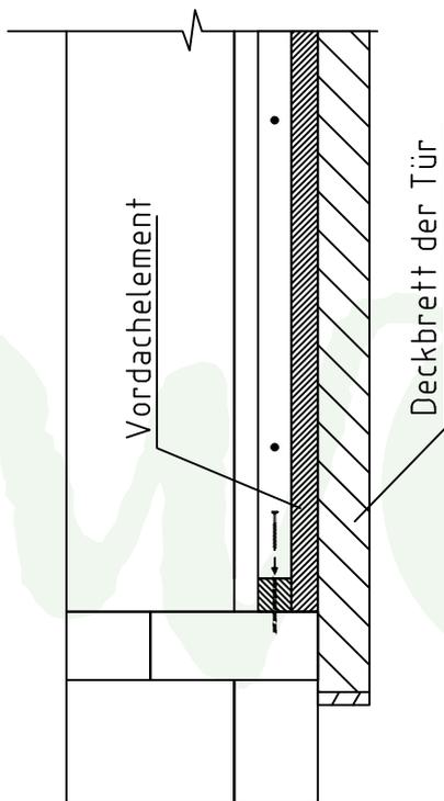
Step 2: Das Deckbrett muss von oben (durch das VD-Element) an das Dachelement verschraubt werden.
